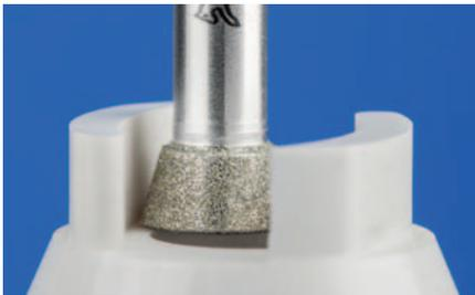
Чашечная форма КТ оптимально подходит для обработки профилей, плоских поверхностей и буртиков, без повреждения цилиндрической поверхности.
