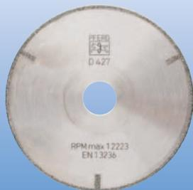
Алмазные шлиф.-отрезные круги на гальванической связке обеспечивают высокую скорость резания. С размером зерен от D 64 до D 427 они используются для резки твердых материалов, таких как твердые сплавы или армированные пластмассы (GFK/CFK).
