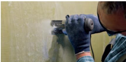
Алмазное ножовочное полотно отлично подходит для обработки армированных пластмасс (GFK/CFK), например, для пропиливания отверстий в емкостях или пиления армированных пластиковых пластин. Алмазное ножовочное полотно характеризуется отличной режущей способностью для производства различных геометрий и высокой стойкостью. Подходит для всех ножовочных пил с зажимом Bosch.
