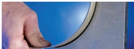
Гибкий материал основы алмазных листовых полотен точно повторяет контуры обрабатываемой поверхности. Это позволяет обрабатывать сложные контуры с меньшими энергозатратами.
