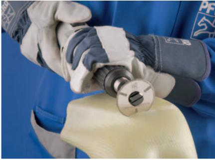
Принадлежности для крепления алмазных отрезных шлифовальных кругов диаметром до 75 мм.
