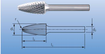
Грибовидной формы борфреза по DIN 8032 с зубом по DIN 8033.
