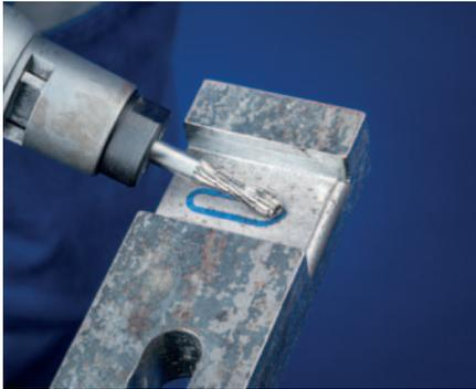
Борфрезы четырёх специальных форм с хвостовиком- $\varnothing$  6 мм. Благодаря их разной конструкции идеально подходят для широкого спектра фрезерных работ.
