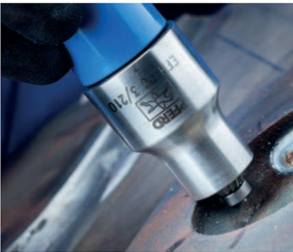
Конической формы борфреза для нанесения дефинированных фасок.
