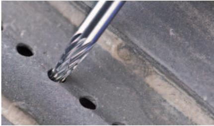
Остроконической формы борфреза по DIN 8032 с зубом по DIN 8033, плоский конический конец.
