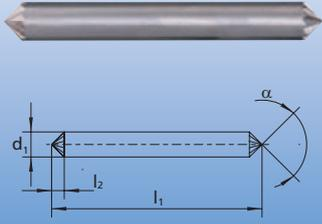
Конической формы борфреза по DIN 8032 и зубом по DIN 8033 с углом (90°). Исполнение KSK 0603/6 имеет зуб с обеих сторон, см. рисунок.
