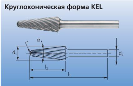
Круглоконической формы борфреза с закругленной головкой по DIN 8032.
