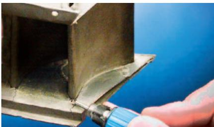
Сферической формы борфреза по DIN 8032 с зубом по DIN 8033.
