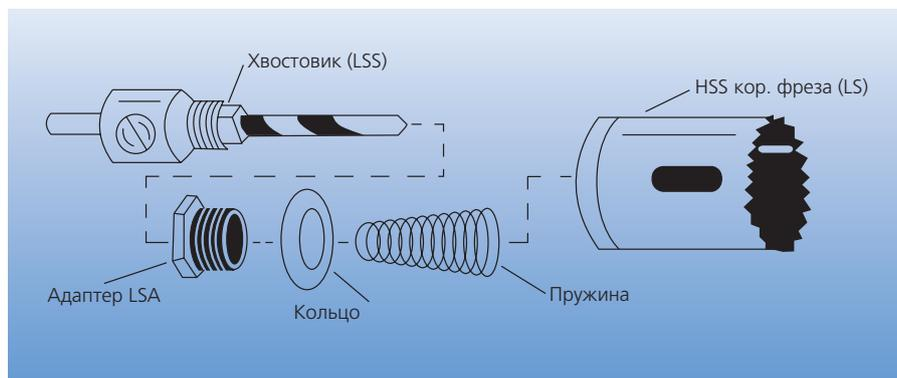
PFERD предлагает зажимную систему для легкой и быстрой смены кор. фрез из быстрорежущей стали (HSS).
