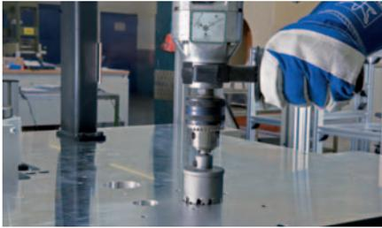
Длинное исполнение (высота инструмента 35 мм) предназначено для обработки изогнутых поверхностей и труб. Максимальная глубина обработки 32 мм.
