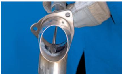
Поконковой формы борфреза по ISO 7755/8 с зубом по DIN 8033.
