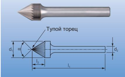
Конической формы борфреза по DIN 8032 с зубом по DIN 8033 с углом (60°). Исполнение KSJ 0605/6 имеет зуб с обеих сторон, см. рисунок.
