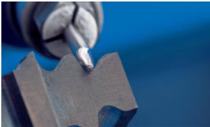
Грибовидной формы борфреза по DIN 8032 с зубом по DIN 8033.
